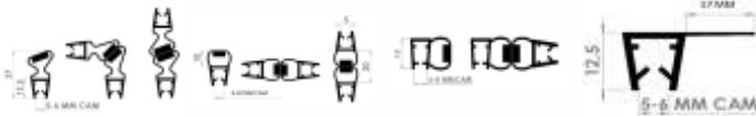
MTCK-014 MC 35-6 MM MANYETİK MTCK-015 MC 180/6-10 MM MANYETİK MTCK-016 MCY 180*6 MM MANYETİK MTCK-017 DC-63*17 MM YAN SULUK
